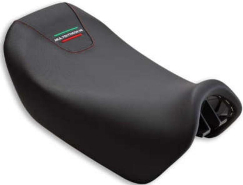
Sella alta riscaldata pilota. L'altezza della seduta, maggiorata di 15 mm rispetto alla versione di serie, unita alla realizzazione in schiumati più compatti e al rivestimento in tessuto tecnico, offre il massimo sostegno e attutisce le asperità del terreno. Il comfort per il pilota è ulteriormente massimizzato grazie al sedile riscaldato, che contribuisce anche a contrastare l'affaticamento nelle giornate più fredde. L'accessorio ideale per godersi al meglio ogni avventura.
