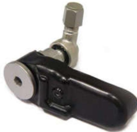
Sensore pressione pneumatici. Accessorio che garantisce il controllo del livello di pressione dello pneumatico, trasmettendo al cruscotto i dati di rotolamento rilevati dai componenti elettronici. Grazie a questo componente, i controlli manuali della pressione diventano superflui, rendendo immediatamente visibili eventuali problemi e garantendo così la massima sicurezza.
