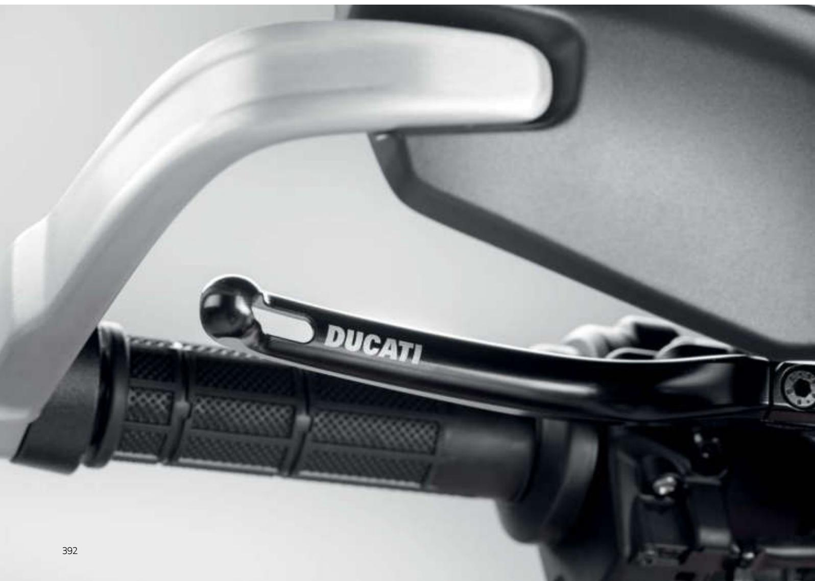
Leva frizione. Realizzata con lavorazione 3D e caratterizzata da una linea tipicamente sportiva. Regolabile e snodata, per ridurre la possibilità di rottura. La leggerezza ed aerodinamicità, unite ad un elevato grip, forniscono un alto livello di performance. Sviluppata in collaborazione con Rizoma.
