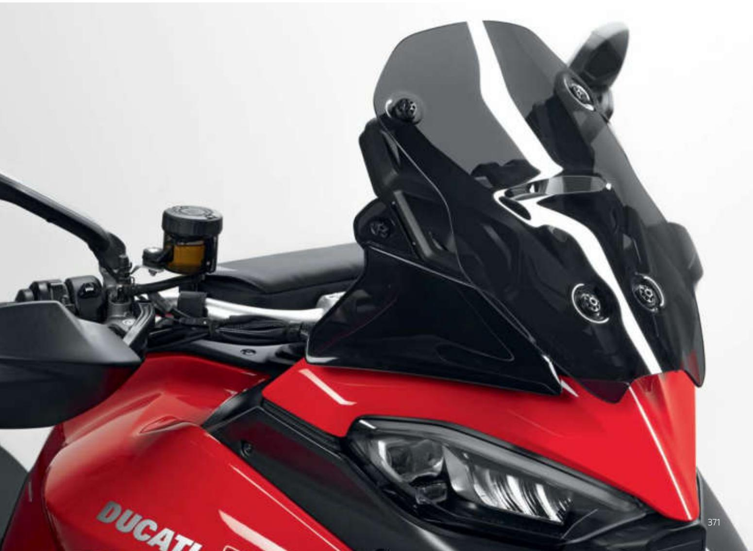
Parabrezza fumè in plexiglass Gran Turismo. Altezza maggiorata per offrire una protezione aerodinamica ottimale. Realizzato con materiali di altissima qualità per garantire resistenza e stabilità. Le eccellenti caratteristiche tecniche, unite a un design che si sposa perfettamente con le linee della moto, lo rendono un accessorio indispensabile nei lunghi trasferimenti, conferendo al contempo un esclusivo tocco di classe alla moto.
