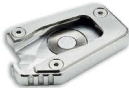
Adattatore per pedane poggiapiedi. Accessorio sviluppato da Ducati in collaborazione con Rizoma per il montaggio delle pedane poggiapiedi. Un dettaglio che si contraddistingue per la sua praticità e per l'alta qualità dell'alluminio anodizzato.
