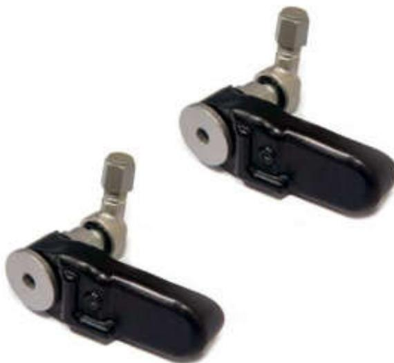
Sensore pressione pneumatici. Accessorio che garantisce il controllo del livello di pressione dello pneumatico, trasmettendo al cruscotto i dati di rotolamento rilevati dai componenti elettronici. Grazie a questo componente, i controlli manuali della pressione diventano superflui, rendendo immediatamente visibili eventuali problemi e garantendo così la massima sicurezza.
