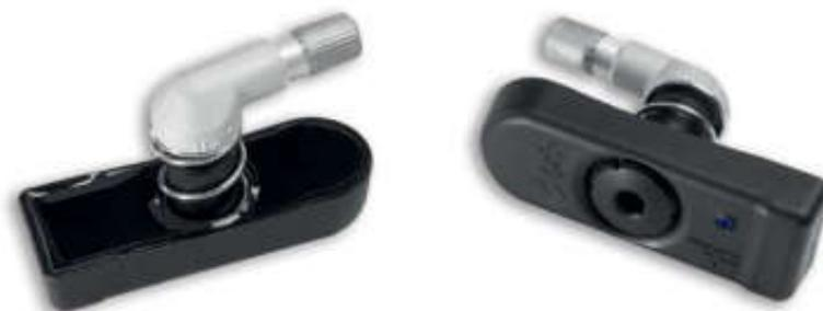
Tappe serbatoio Hands-free. Grazie al sistema ad apertura elettrica il rifornimento carburante diventa veloce e senza necessità di chiave. Si sblocca automaticamente allo spegnimento della moto e si blocca di nuovo dopo 60 secondi in caso di mancato rifornimento.
