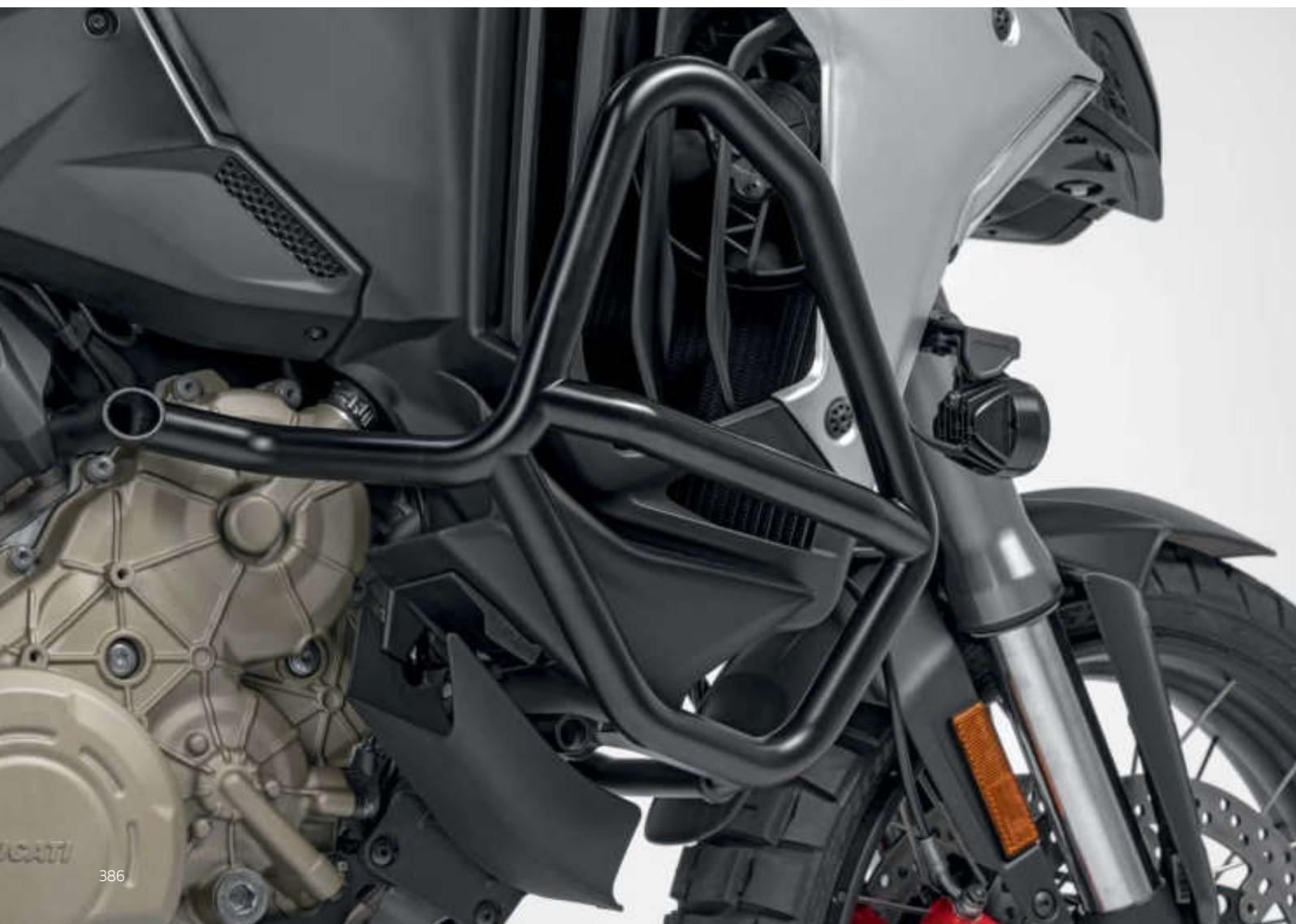
Paramotore in tubi d'acciaio. L'accessorio perfetto per proteggere il motore da cadute accidentali e dai possibili urti derivanti dall'uso della moto su percorsi accidentati. Il design lineare e il finishing dell'acciaio esaltano il look inconfondibile della moto con un tocco di aggressività.
